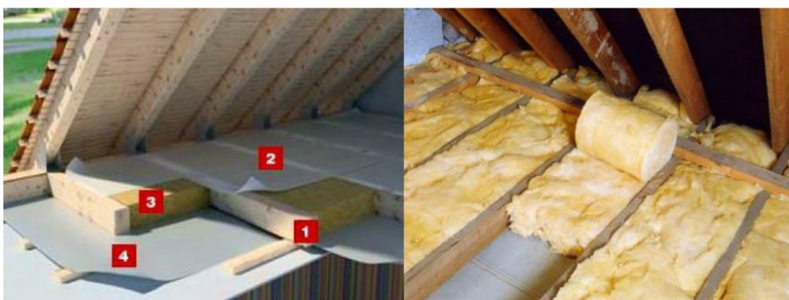
1 - вологонепроникний шар; 2 - мембранний шар; 3 - мінеральна вата; 4 - супердифузійна мембрана.
